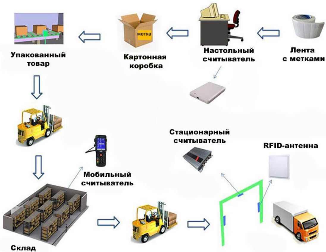
Рисунок 3.1 – схема работы при использовании RFID-технологии
