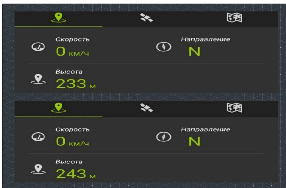
Рисунок 2.6 – Определение продольного уклона с использованием GPS
