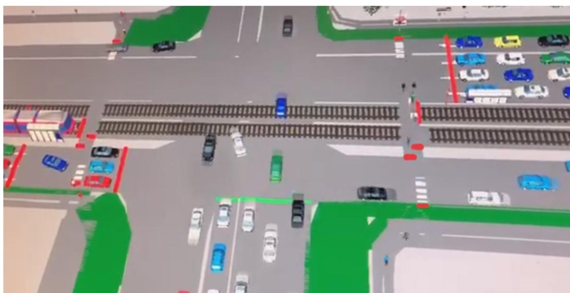
Рисунок 2.13 – Имитационное моделирование в программе «PTV Vissim»
