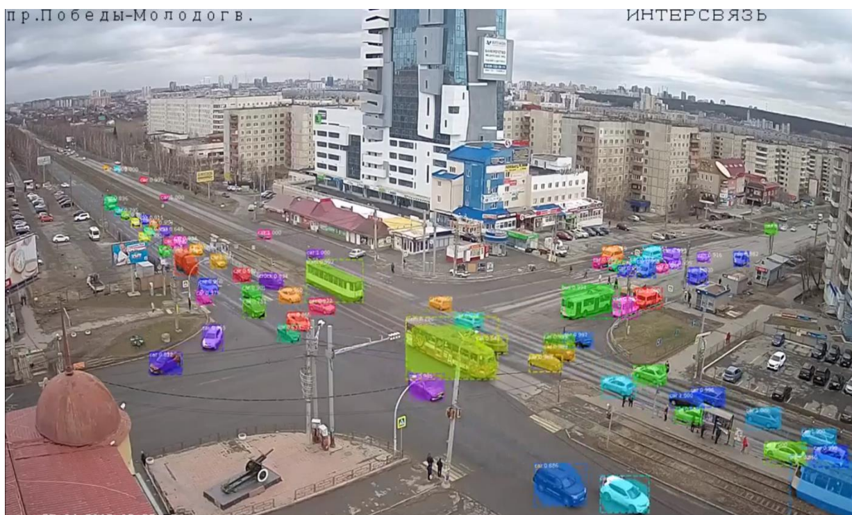
Рисунок 2.11 – Анализ дорожно-транспортной обстановки с помощью камеры
