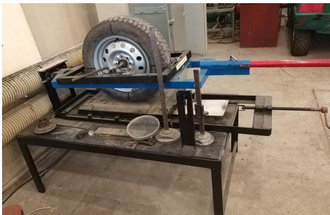
Рисунок 4.2 – Пример установки колеса на стенд
