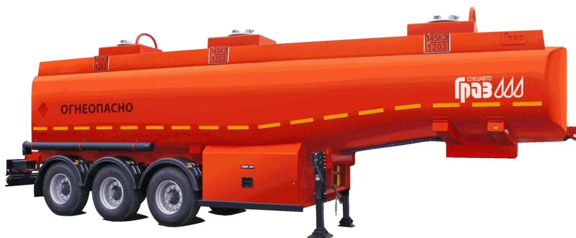
Рисунок 3.2 Полуприцеп – цистерна ППЦ-96227-05
