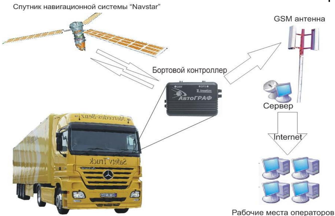
Рисунок 3.6 – Принцип работы системы «АвтоГРАФ»
