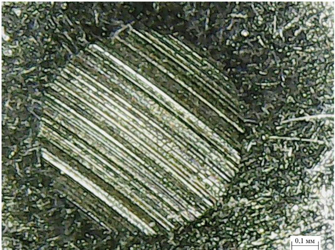
Рисунок 3.19 – Пятно износа при испытании Eni 2t + 1% олеата меди
