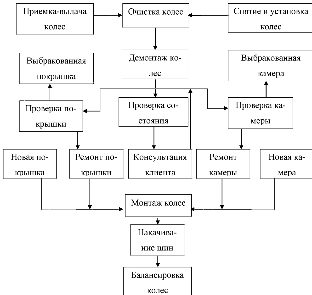
Рисунок 2.1 – Технологический процесс шиномонтажной мастерской
