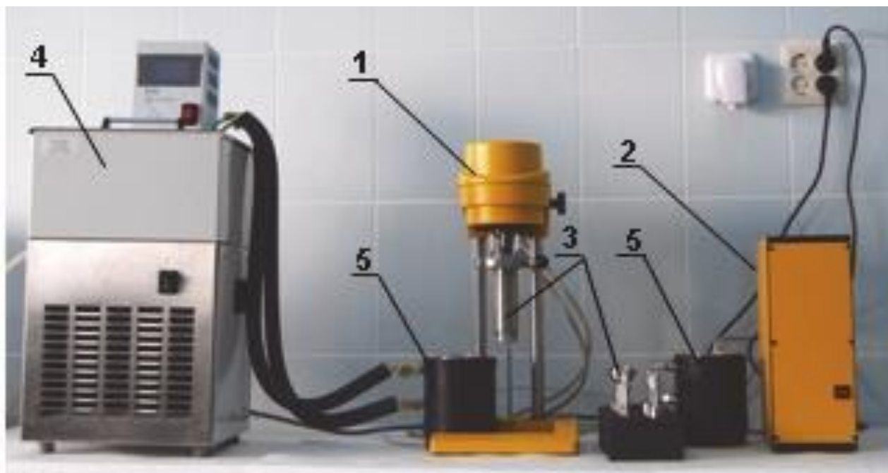
Рисунок 2.10 Измерительный комплекс Rheotest RN 4.1:
