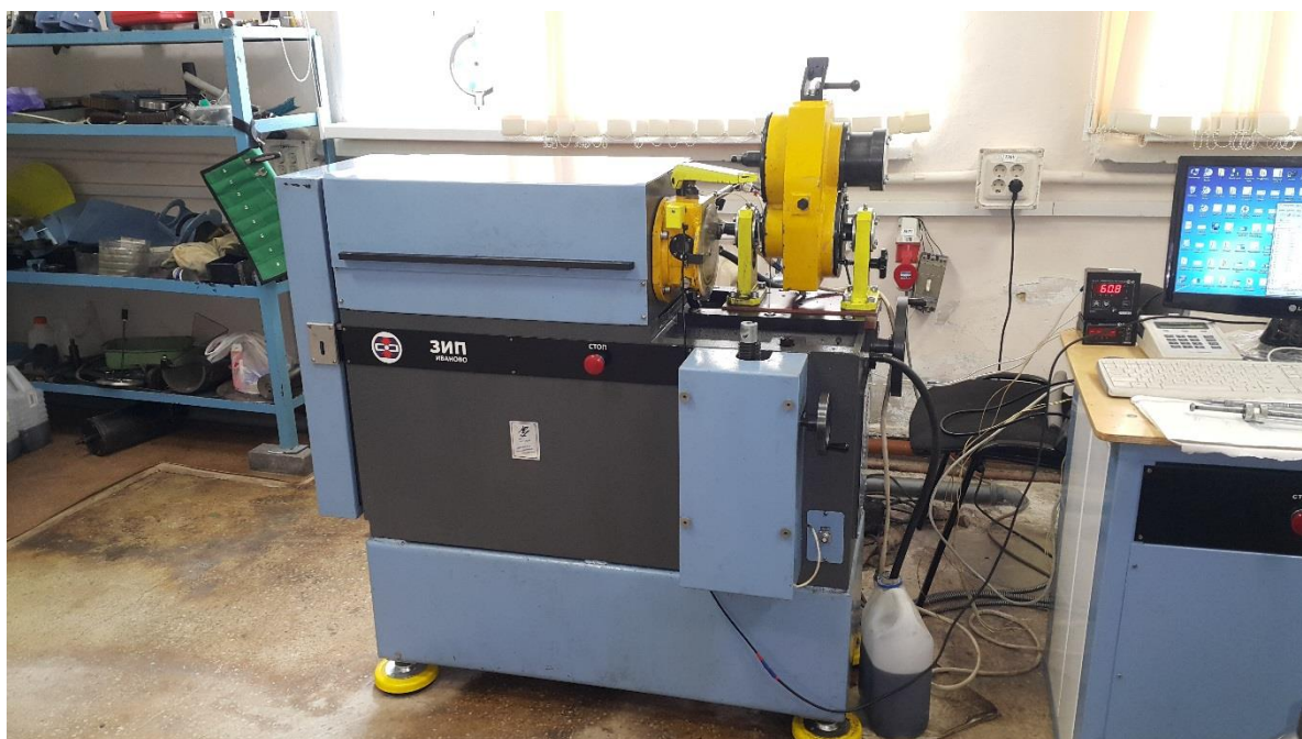
Рисунок 2.12 – Внешний вид машины трения ИИ-5018
