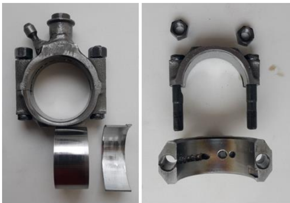
Рисунок 2.14– Шатунный подшипник ВАЗ 2108
