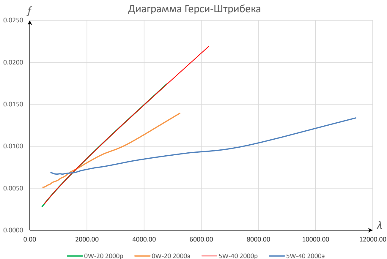
Рисунок 5.2 – Расчетная и экспериментальная диаграммы Герси-Штрибека при 2000 об/мин.
