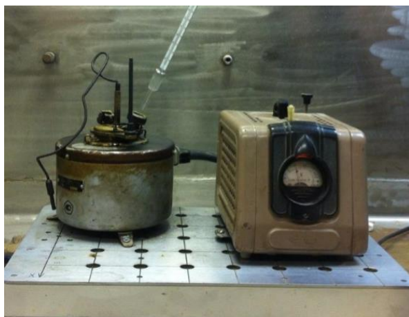
Рисунок 7 – Аппарат Пенски-Мартенса для определения температуры вспышки:
