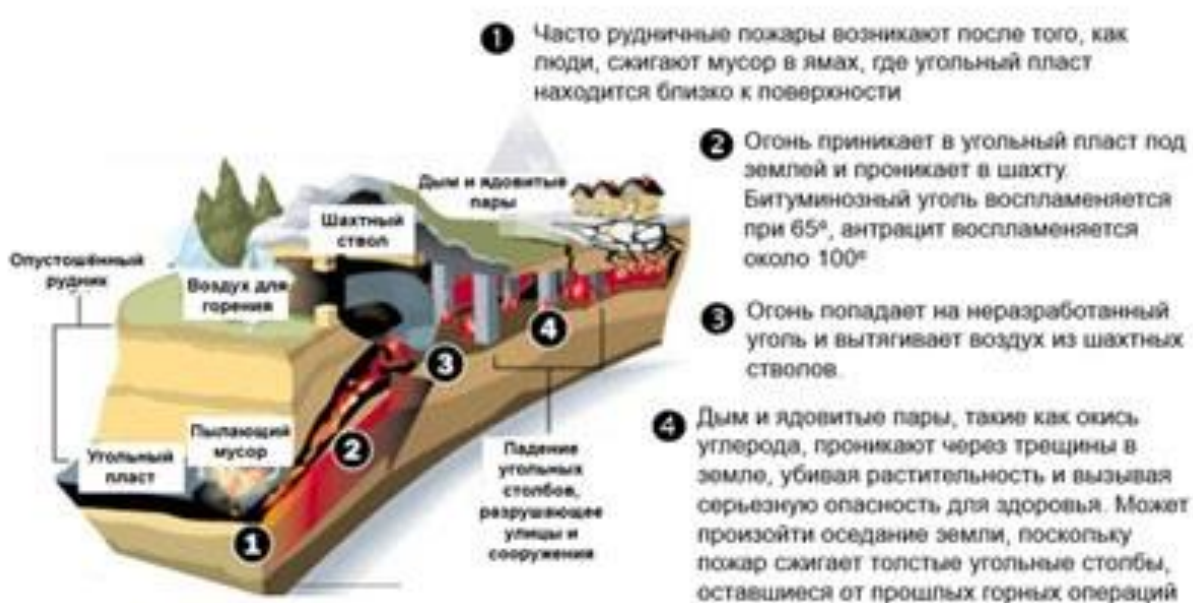
Рисунок 2 – Вариант возникновения и развития экзогенного пожара на угольной шахте
