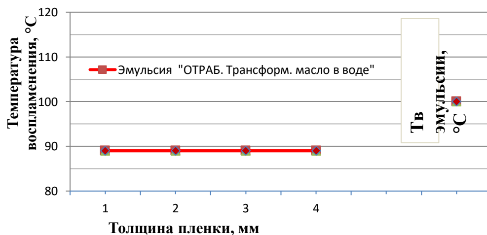
Рисунок 30 – Температура воспламенения эмульсии "Отработанное трансформаторное масло в воде"
