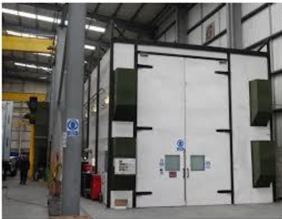
Рисунок 2 – Дробеструйная камера CLEMCO для кузовов и прицепов
