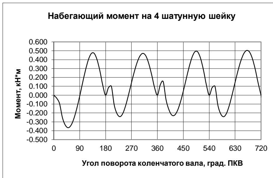
Рисунок 5.6 - Развернутая диаграмма нагрузок на шатунную шейку в прямоугольных координатах
