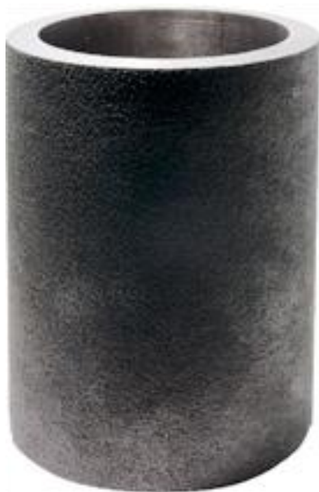
Рисунок 2 – Заготовка чугунной гильзы для ремонтных работ.
