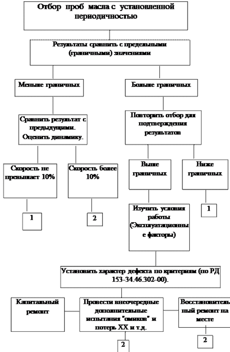
Рисунок 5 - Структурно-логическая схема диагностики по результатам ХАРГ
