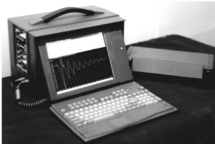
Рисунок 5 – Диагностическая установка «Импульс-8С» для дефектографирования обмоток трансформаторов методом частотного анализа
