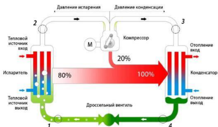
Рисунок 2.1 – Схема функционирования типового теплового насоса
