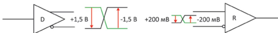
Рисунок 7 - Минимальные уровни сигналов в линии RS-485
