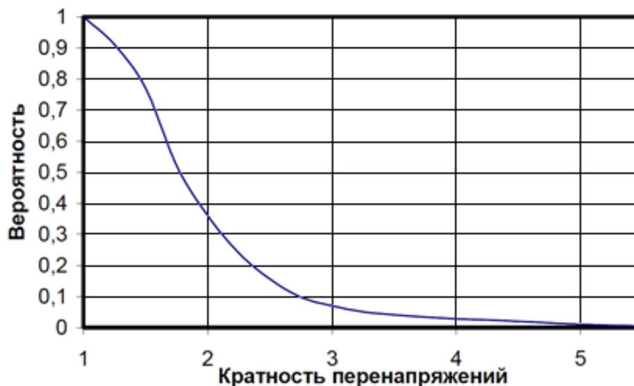
Рисунок 4.7 – Кривая вероятностей перенапряжений при отключении ненагруженных трансформаторов с изолированной нейтралью
