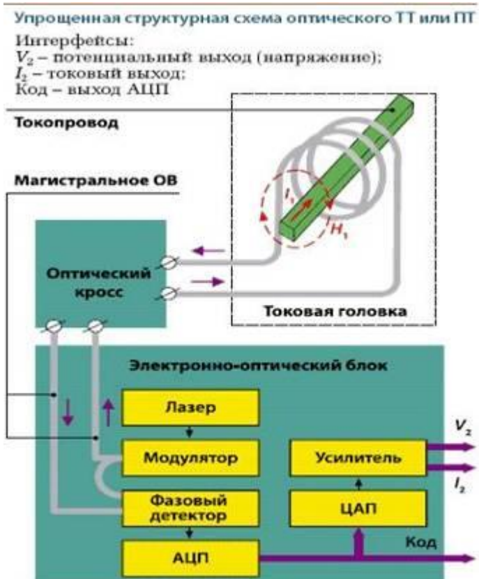
Рисунок 13 – Упрощенная структурная схема оптического ТТ или ПТ
