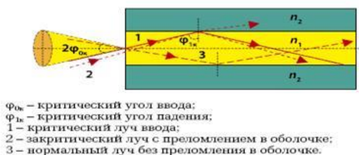
Рисунок 11 – Схема ввода светового луча в торец ОВ для реализации процесса ПВО
