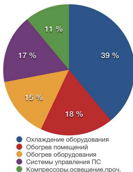
Рисунок 6.1 – Структура расхода на собственные нужды подстанции
