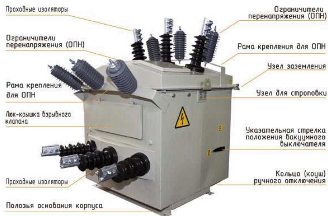
Рисунок 15 – Устройство реклоузера
