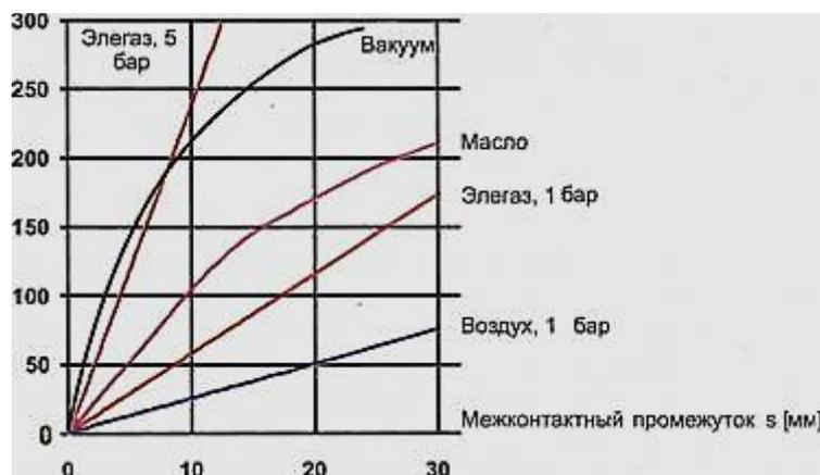
Рисунок 12 - Зависимость напряжения пробоя от межконтактного промежутка
