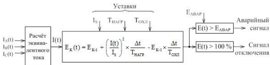
Рисунок 10.2 Алгоритм действия защиты 49RMS
