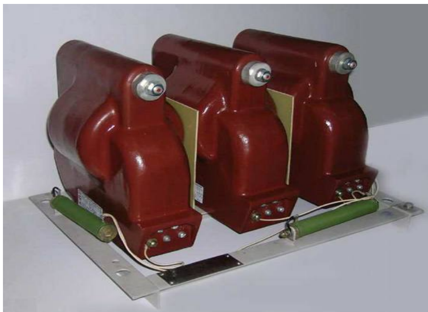
Рисунок 38 – Комплект трансформаторов напряжения 3*ЗНОЛ-06-6 Трансформатор напряжения установлен на каждой секции сборных шин. Подсчет вторичной нагрузки приведен в таблице 54.
