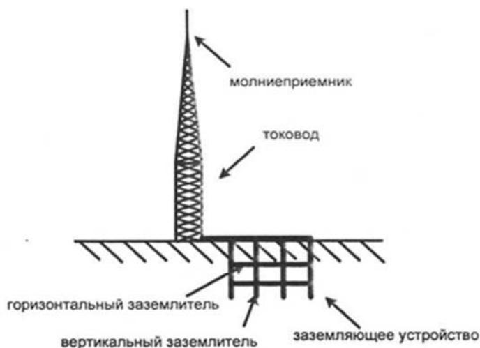
Рисунок 20 - Конструкция типичного молниеотвода
