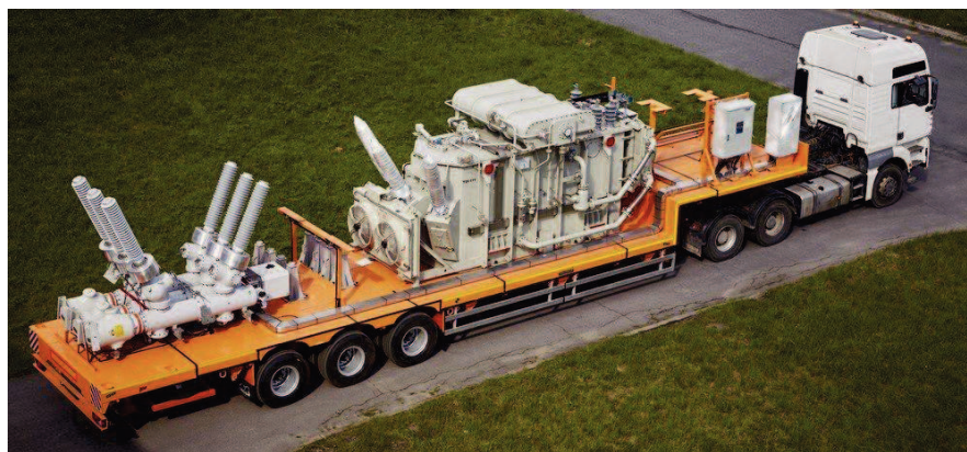
Рис.3.4 Мобильная подстанция 110/10 кВ с использованием КРУЭ
