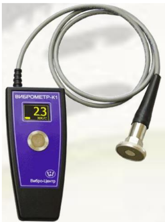
Рисунок 3.12 – Внешний вид прибора «Виброметр-К1»
