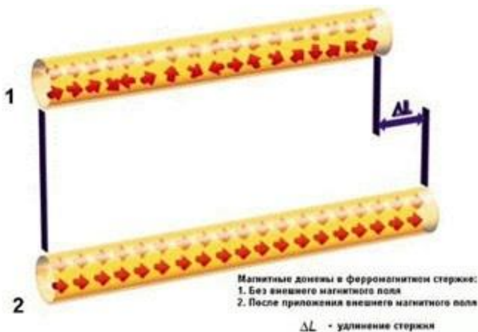
Рисунок 2.1 – Удлинение ферромагнитного стержня под действием электрического поля
