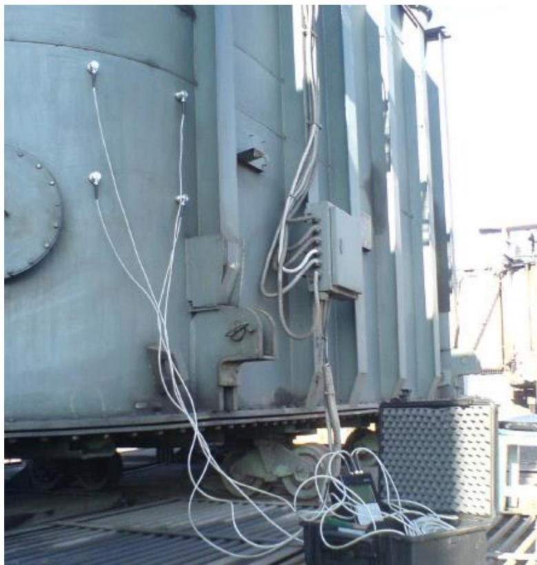
Рисунок 2.17 – Пример установки датчиков прибора AR700
