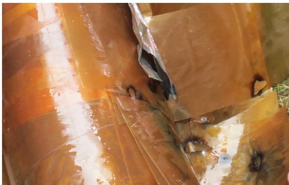
Рисунок 1.4 – Пробой изоляции вследствие развития ЧР
