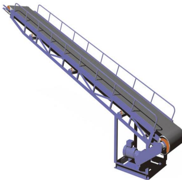
Рисунок 2 – Ленточный конвейер наклонного типа
