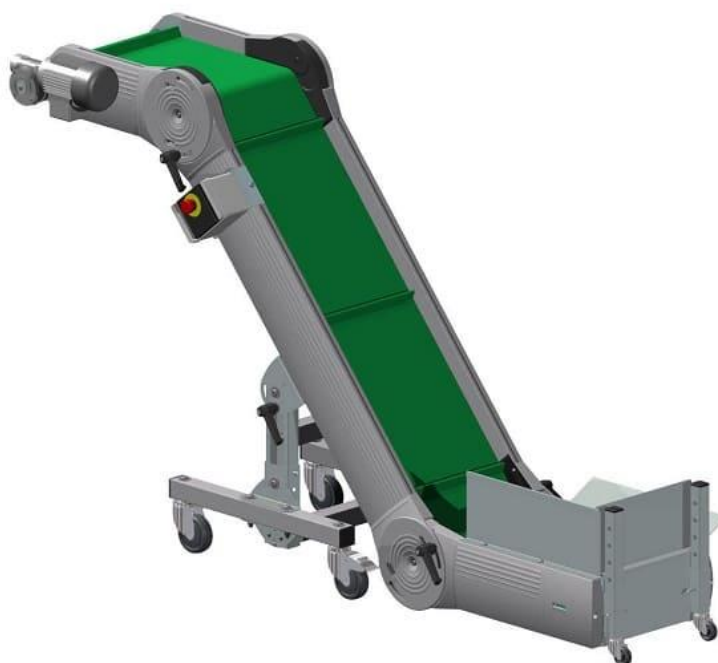
Рисунок 3 – Наклонный ленточный конвейер
