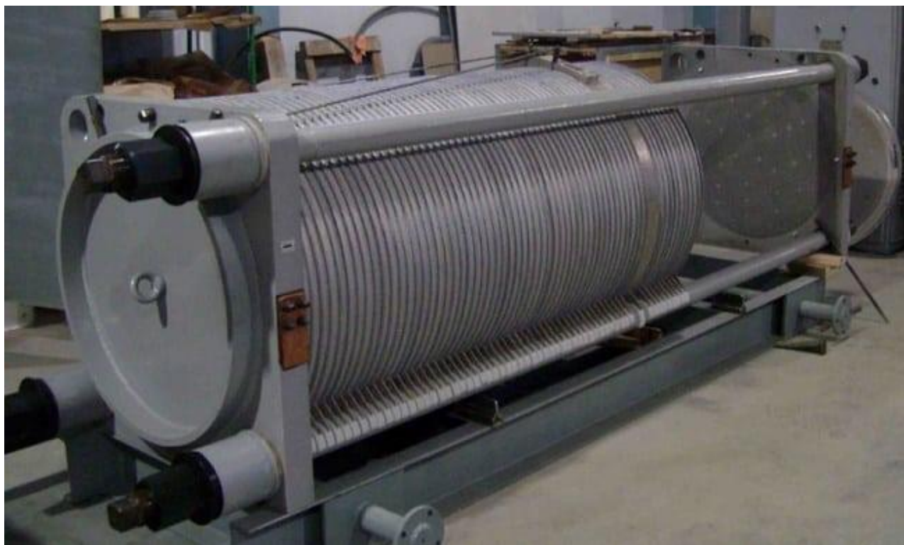
Рисунок 2.1 – Промышленная стационарная электролизная установка, вырабатывающая 40 м 3 водорода в час (СЭУ-40).
