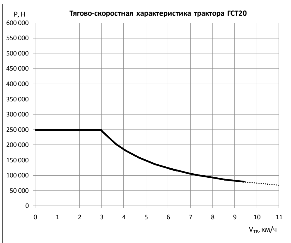
Рисунок 2.4 – Тягово-скоростная характеристика трактора на транспортном режиме ( i=70 ).
