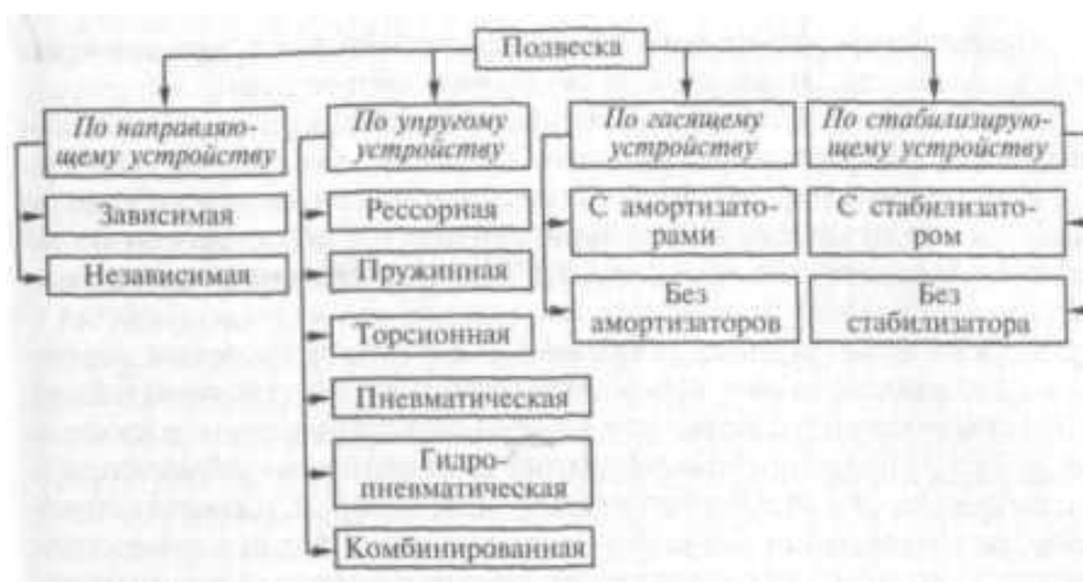
Рисунок 1.9 – Типы подвесок, классифицированных по различным признакам
