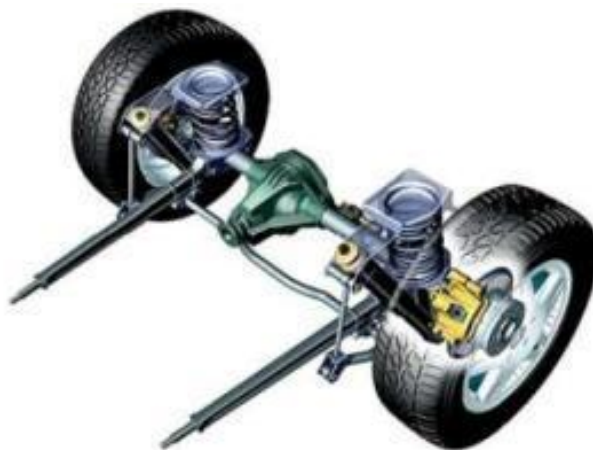
Рисунок 2.1 – Вид общий задней зависимой подвески заднеприводного автомобиля категории M_1
