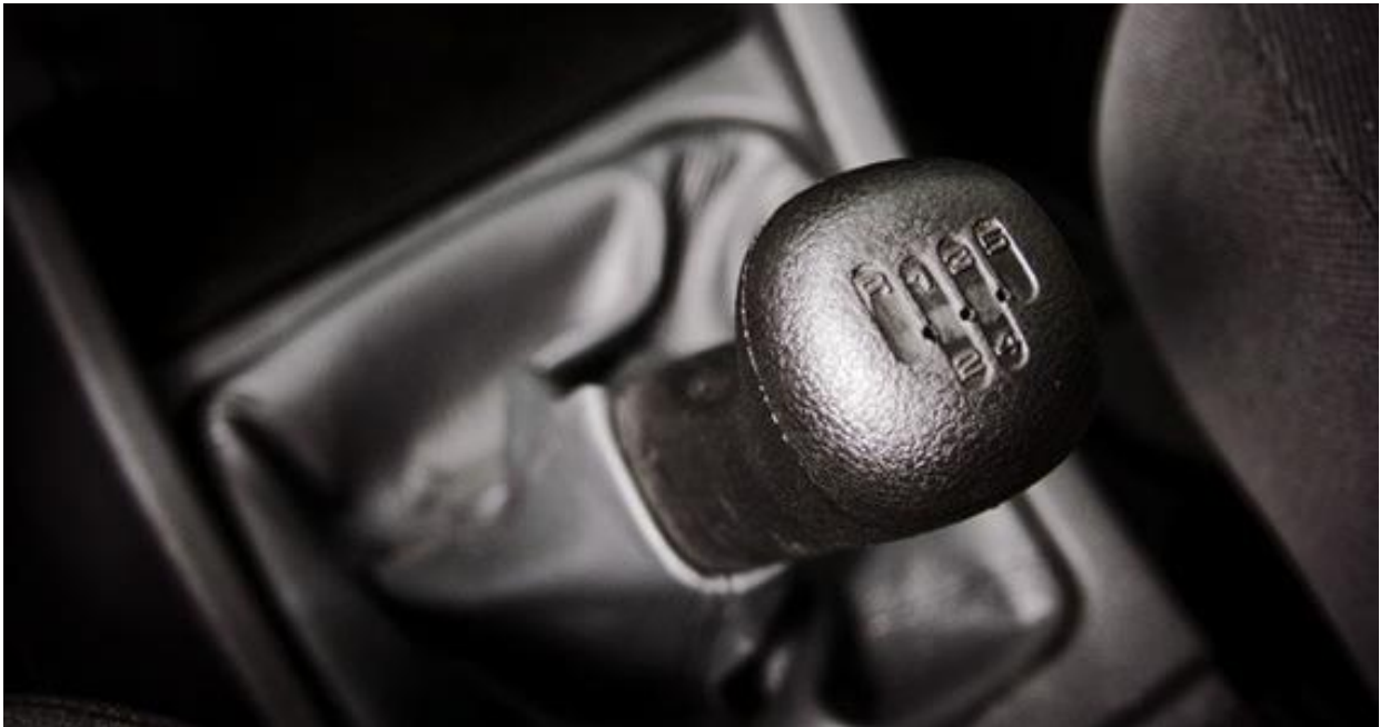
Рисунок 2.16 – Ручка рычага переключения передач пятиступенчатой КПП ВАЗ
