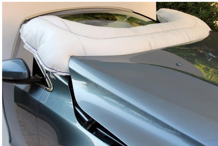
Рисунок 2.3 – Пример открывания капота и надувание подушки
