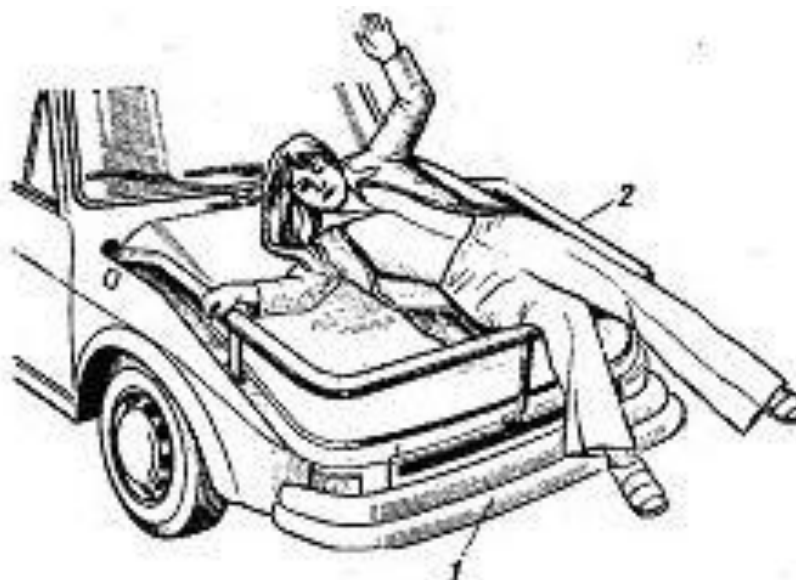
Рисунок 2.2 –Защитная рамка, устанавливаемая ранее английских автомобилях 1-автомобиль; 2-защитная рамка
