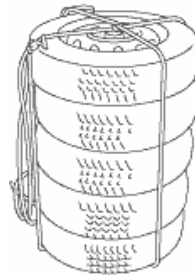
Рисунок 5.5 – Установка дополнительных шин
