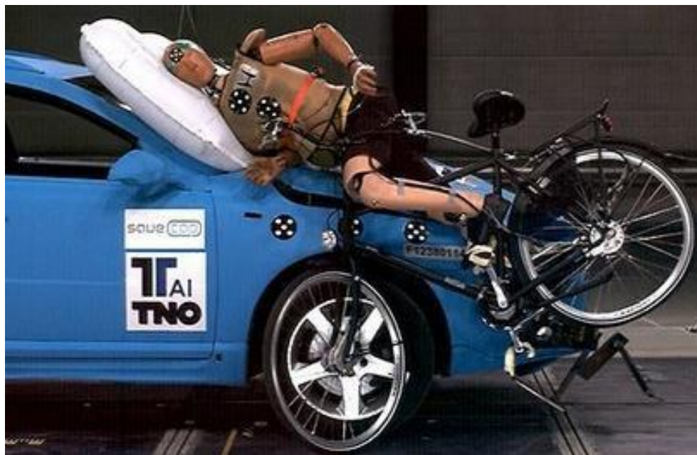
Рисунок 1.1 – Пример установки внешней подушки безопасности
