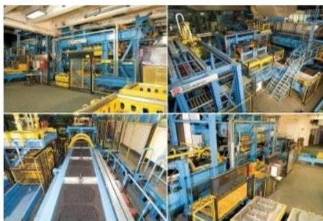
Рисунок 3 – Автоматическая формовочная опочная линия EFA-SD8
