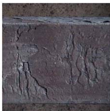
Рисунок 9 – Продольное сечение образца заготовки в месте расположения заливны (а) и ее фото на поверхности заготовок (б, в)
