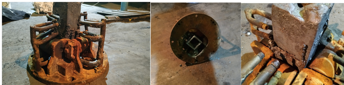
Рисунок 3.2 – Результат зависания корочки слитка
