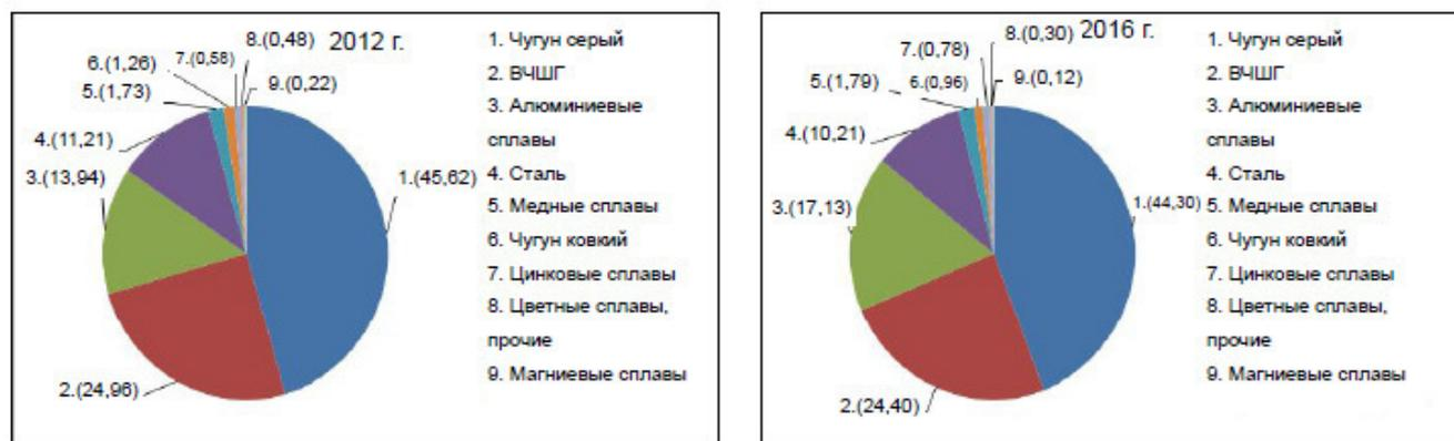
Рисунок 1.2 – Металлоструктура литья (%), производимого в мире в 2012 и 2016 гг. [1]
