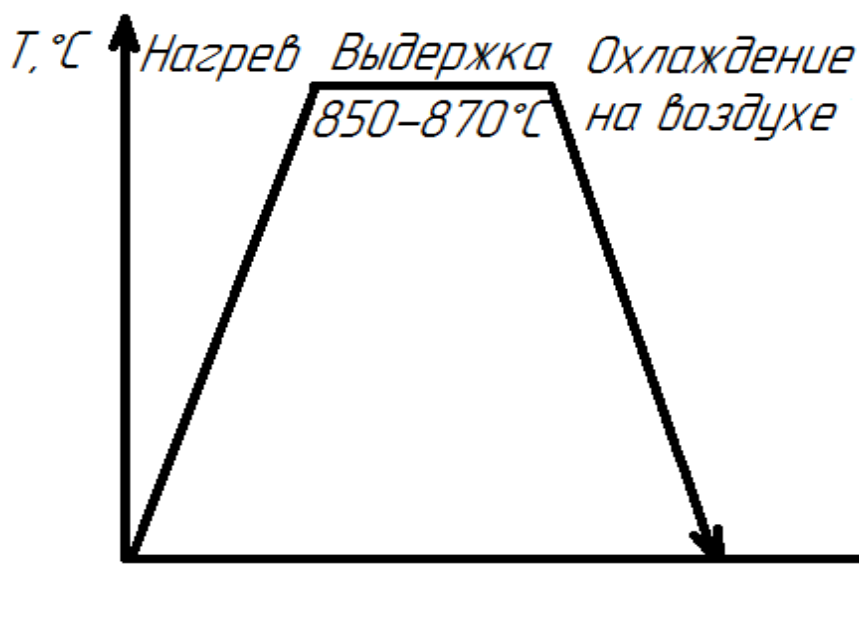
Рисунок 9 – Режим предварительной термической обработки (нормализация)
