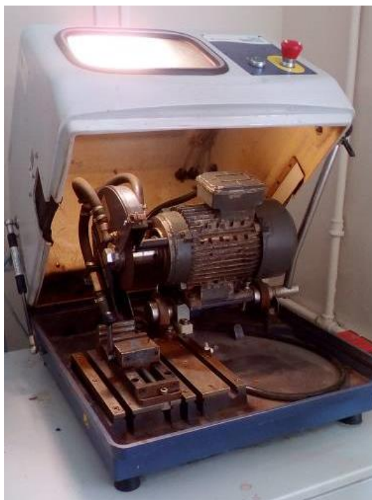
Рисунок 2.2 – Отрезной станок Delta Abrasimet
