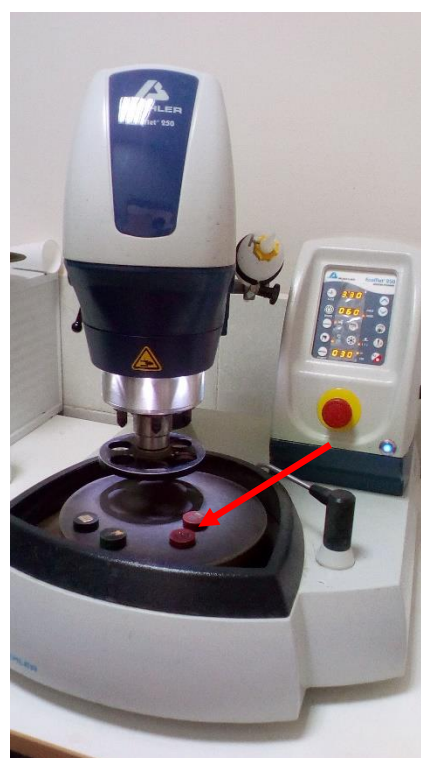
Рисунок 2.4 – Полуавтоматическая шлифовально-полировальная машина EcoMet 250+AutoMet 250 и обрабатываемые образцы
