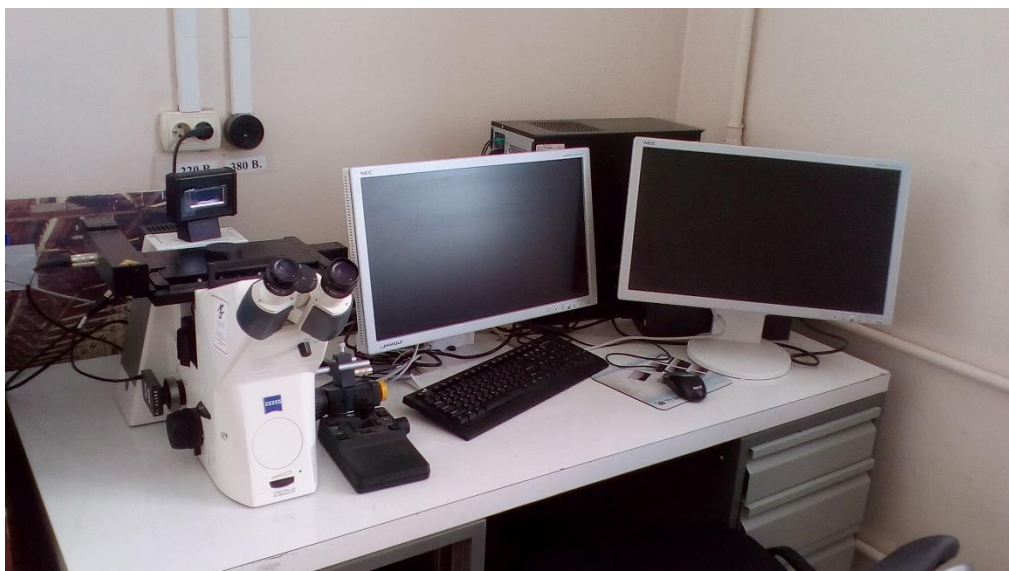
Рисунок 2.5 – Металлографический микроскоп Axio Observer
