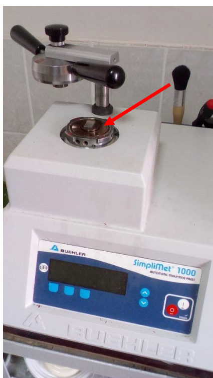
Рисунок 2.3 – Пресс для горячей запрессовки SimpliMet 1000 и запрессованный образец
