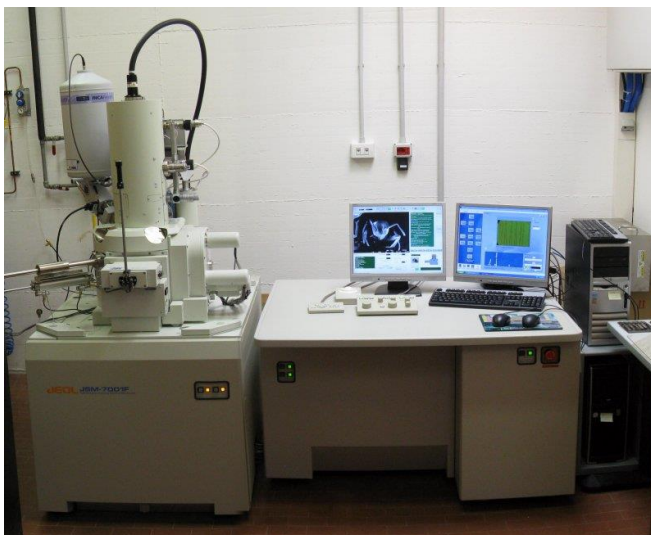
Рисунок 2.1 – Растровый электронный микроскоп JEOL JSM-6460 ULV
