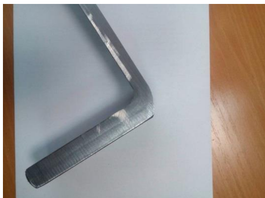
Рисунок 2.2 – Внешний вид несоответствия «притупления прямых углов» и «скоса прямого угла по полке», вследствие не заполнения металлом.
