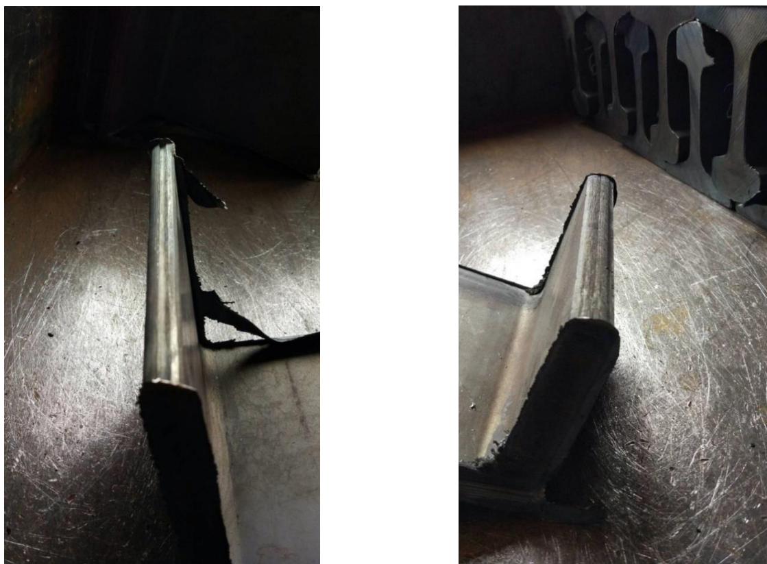
Рисунок 2.5 – Наличие переполнения калибров металлом («ус») на сварной и опорной полке профиля Z310.
