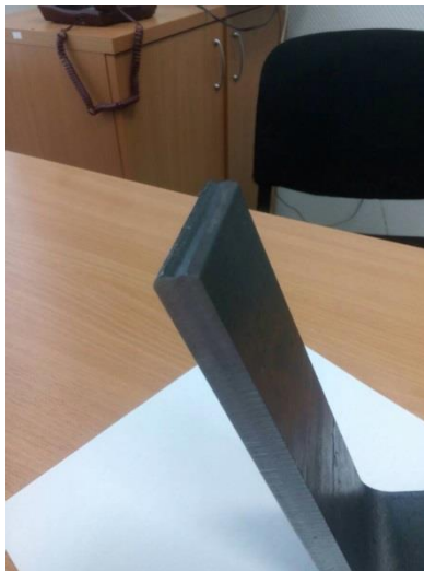
Рисунок 2.3 – Дефект поверхности типа «ус» на торце сварной полки.
