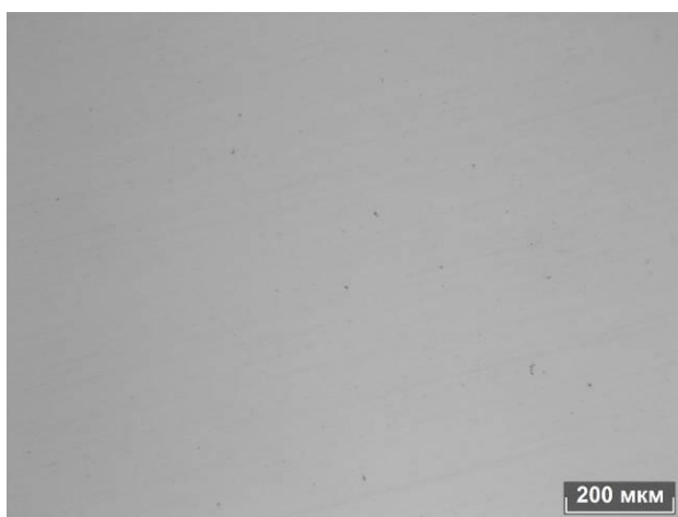
Рисунок 17 – Неметаллические включения в образце 10-3, x100
