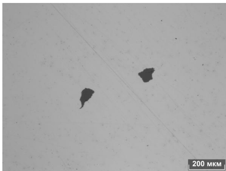
Рисунок 16 – Сложные по составу неметаллические включения в образце 25-2, x100
