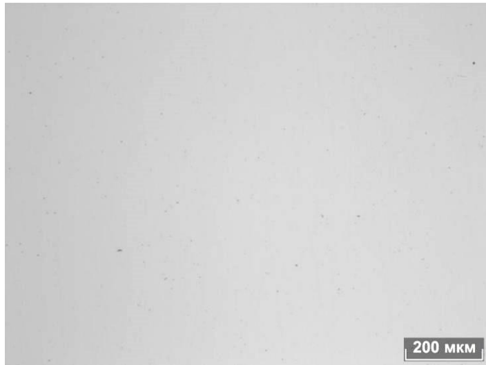
Рисунок 13 – Неметаллические включения в образце 25-3, x100
