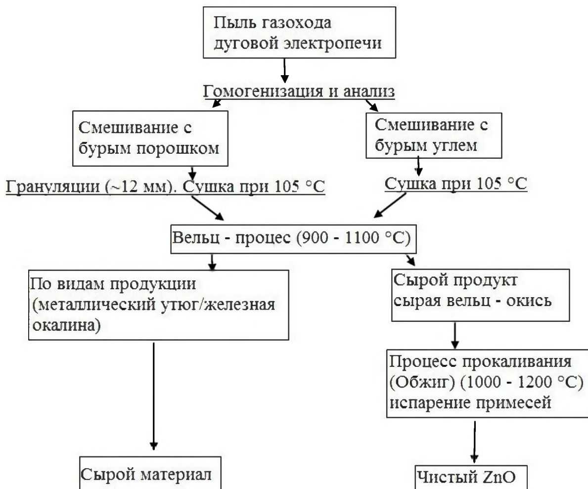
Рисунок 1.6 – Блок-схема пирометаллургической обработки на ЭДП
