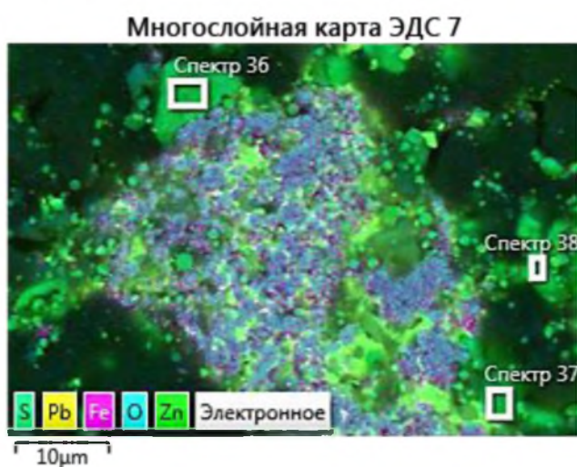
Рисунок 3.7 – Координаты точечного РСМА фаз, Образец 7, поле 1
