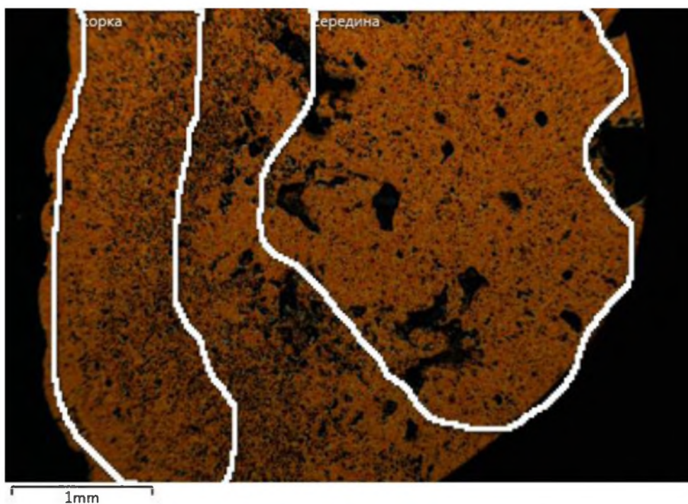
Рисунок 3.14 – Карта зон для определения химического состава внешней («корка») и внутренней («середина») частей окатыша, Окатыш, поле 3
