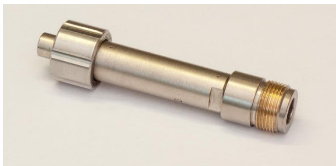
Рисунок 4 – Отрезок коаксиальной линии передачи с воздушным заполнением
