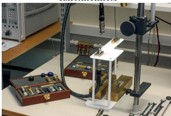
Рисунок 4 – Отрезок коаксиальной линии передачи с воздушным заполнением
