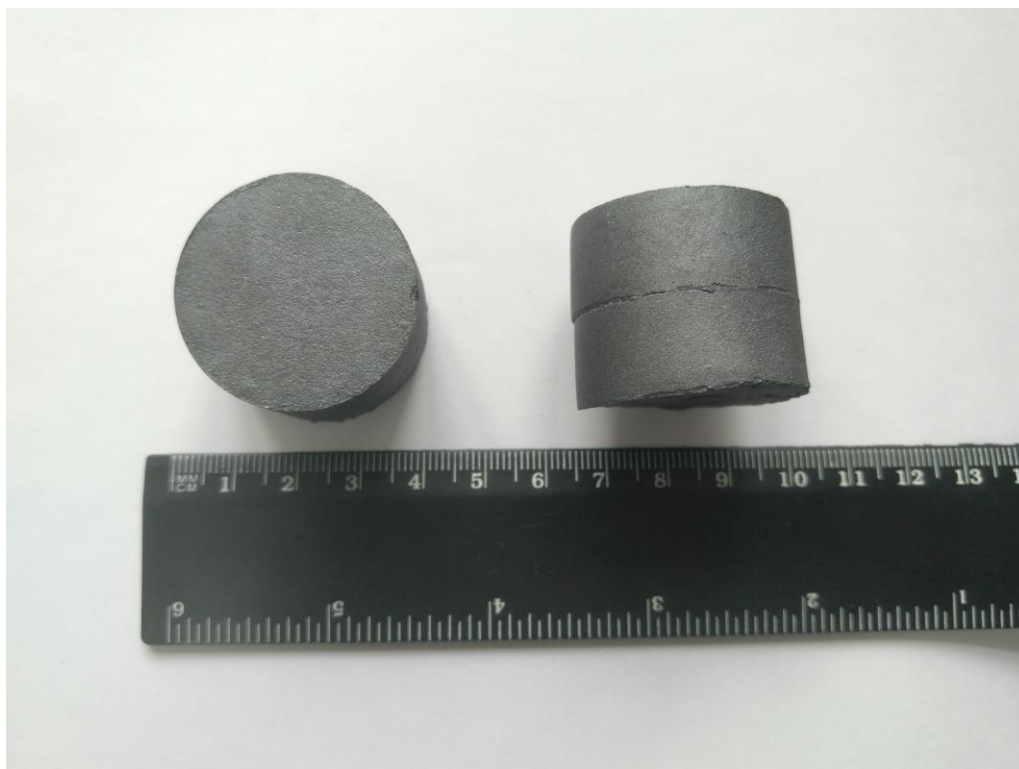
Рисунок 6 – Образцы феррита бария модифицированного титаном
