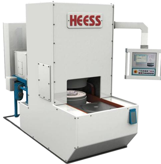
Рисунок 15 – Закалочный пресс Heess серии SP [19]
