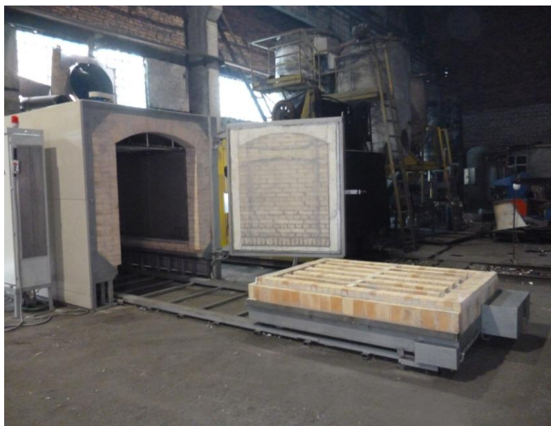
Рисунок 11 – Камерная печь СДО-14.28.10/10
