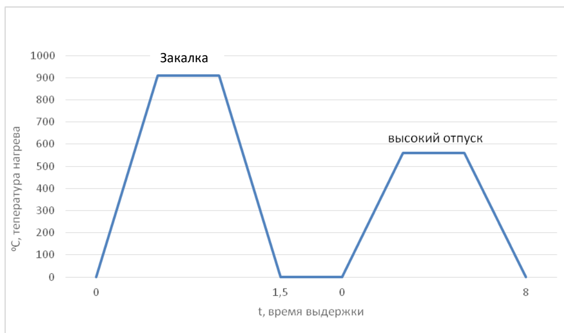
Рисунок 7 – Схема термической обработки коленчатого вала
