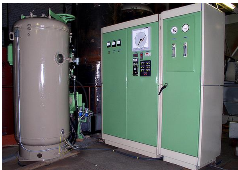
Рисунок 12 – Установка ионного азотирования ЭВТ 60
