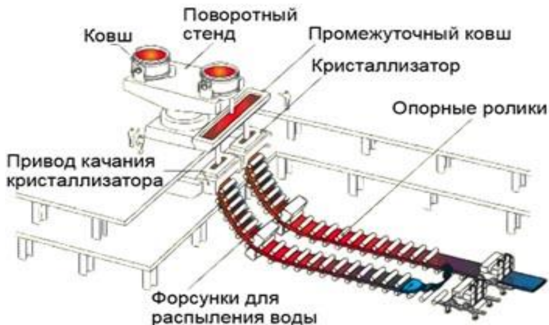
Рисунок 3 – Общая схема разливки стали на МНЛЗ
