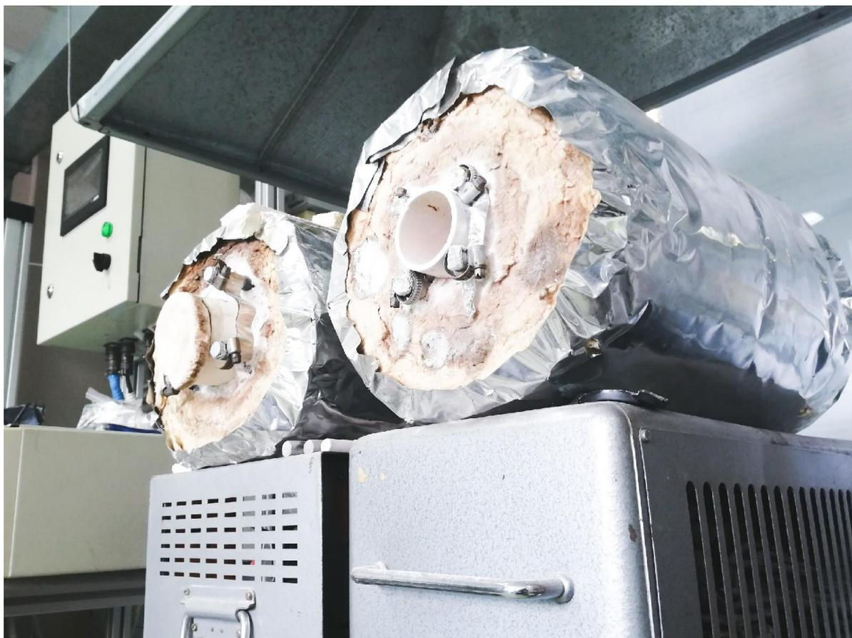
Рисунок – 7 Трубчатая печь сопротивления с карбидкремниевыми нагревателями
