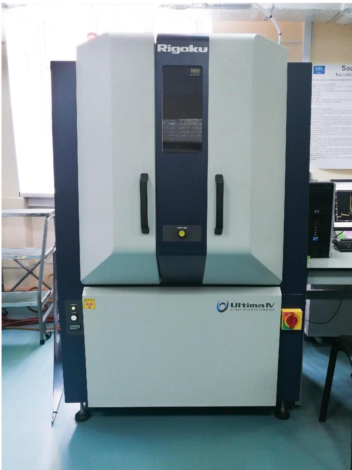
Рисунок – 11 Дифрактометр Rigaku Ultima IV
