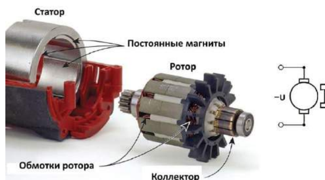
Рисунок 1.6 – Составные элементы коллекторного двигателя
