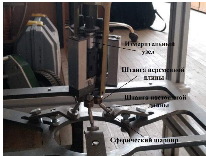
Рисунок 1.3 – Измерительные узлы и электродвигатели на нижней пластине
