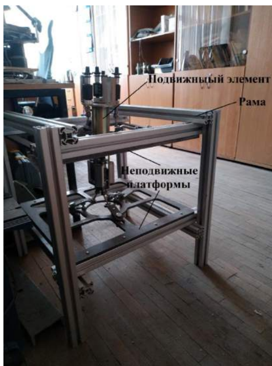
Рисунок 1.1 – Внешний вид объекта автоматизации
