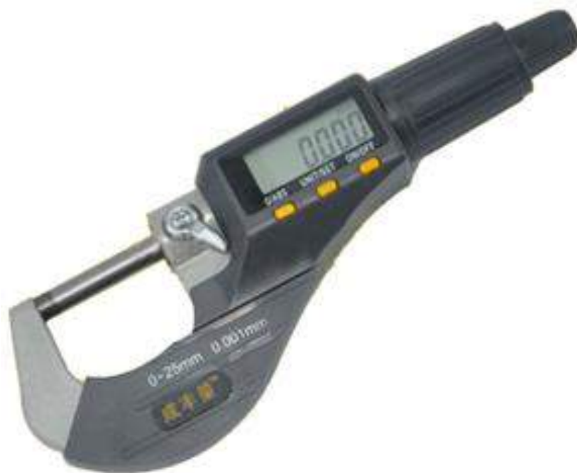
Рисунок 1.4 – Внешний вид цифрового микрометра
