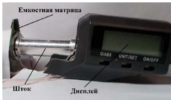
Рисунок 1.5 – Составные элементы измерительного узла
