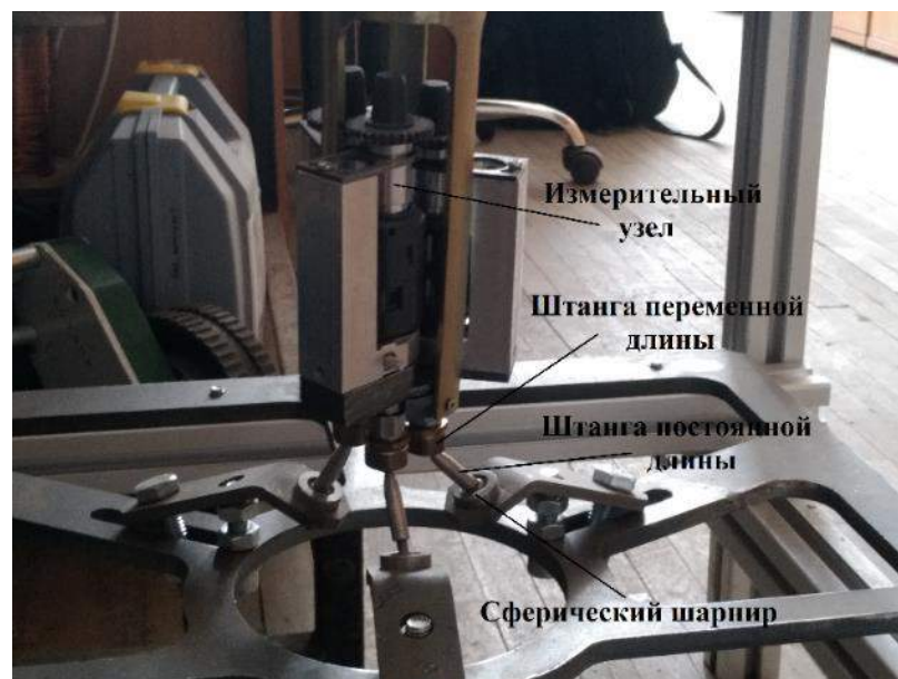
Рисунок 1.3 – Измерительные узлы и электродвигатели на нижней пластине
