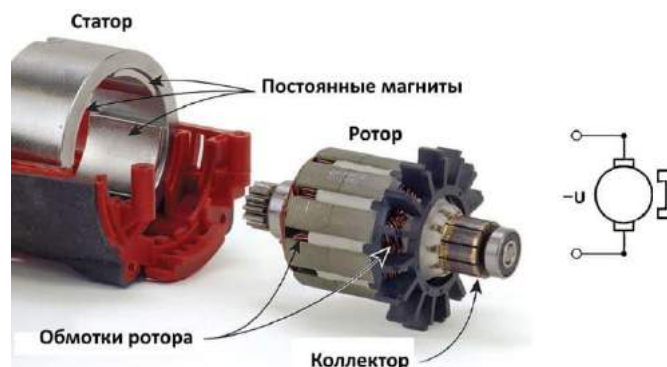
Рисунок 1.6 – Составные элементы коллекторного двигателя
