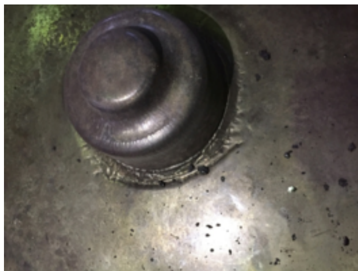
Рисунок 1.5 – Трещина в фигуре штампа
