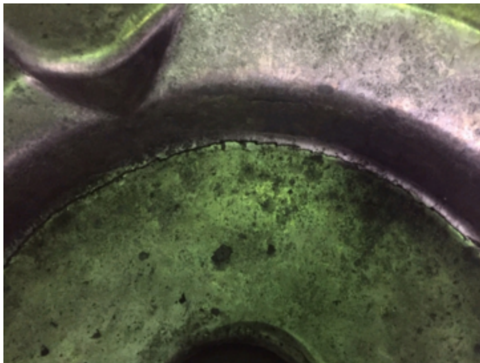
Рисунок 1.2 – Трещина в зоне радиусного перехода
